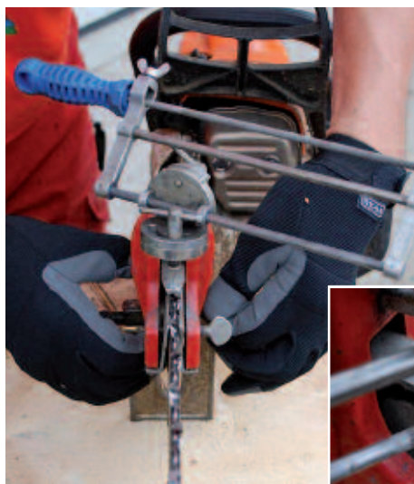
Die Feilhilfe wird auf das Motorsägenschwert geklemmt.
