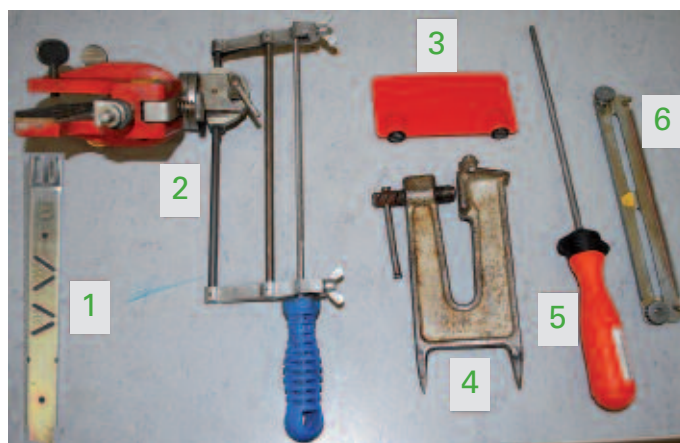
Die Werkzeugkiste des Kettenschleifers: Tiefenbegrenzungslehre (1), Feilenzwangführung (2), Schärfgitter aus Kunststoff (3), Feilbock (4), Feile (5), Feilenhalter (6).
