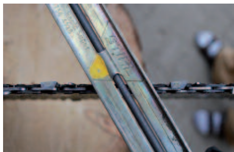
In den Feilhalter wird die Feile eingeschraubt.
