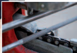
Die Feilhilfe wird auf das Motorsägenschwert geklemmt.
