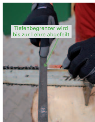
Die Feilhilfe wird auf das Motorsägenschwert geklemmt.
