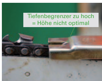
Die Feilhilfe wird auf das Motorsägenschwert geklemmt.
